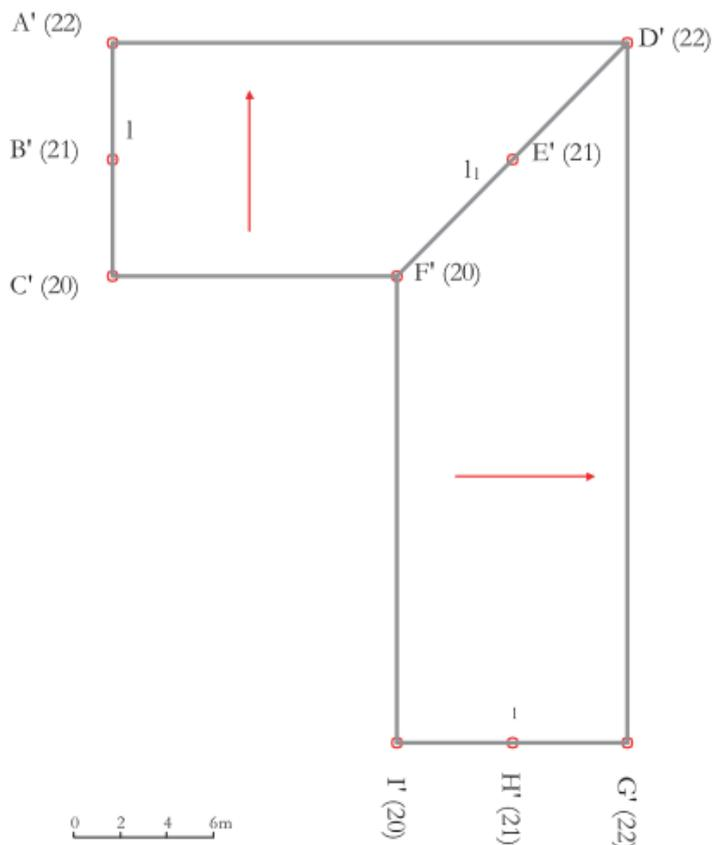
Assegnata la pianta delle coperture di un edificio, determinare la pendenza delle varie falde
