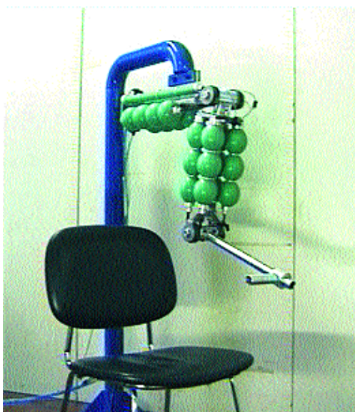
Macchina per riabilitazione di arto superiore azionata da muscoli pneumatici
