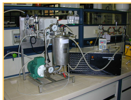
Sistemi di filtrazione a membrana
